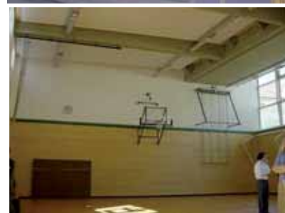
Slika 3: Športna dvorana Turnhalle v Heilbergu, Kirchheim v standardu pasivne gradnje, namenjena šolarjem in krajanom. Obodni masivni zidovi so izolirani s 30 cm ekspandiranega polistirena, streha je prekrita s 40 cm mineralne volne, blaga enokapnica je ozelenjena.
